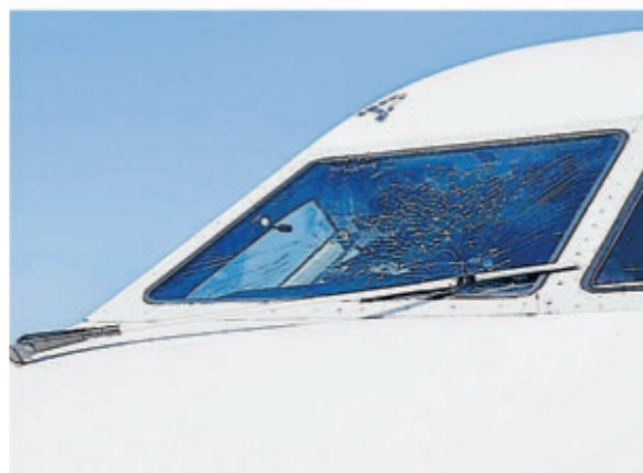
Die zerstörte Frontscheibe der Luxair-Maschine.
